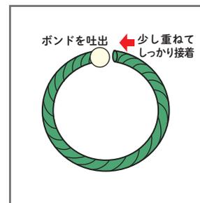
2.1 を丸く曲げ、接合部にボンドを吐出し、接着します。
